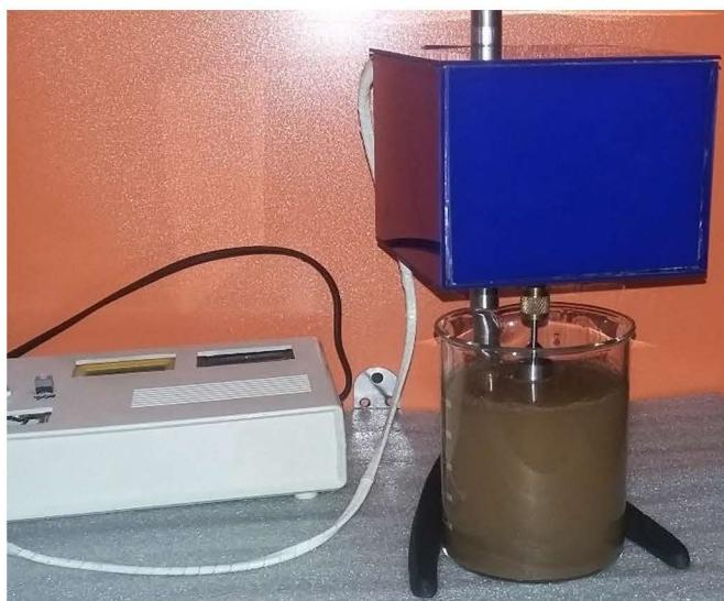
شکل ۱۰. نمایی از دستگاه در هنگام کار به منظور محاسبه ویسکوزیته سوسپانسیون آب و خاک برای محاسبه توان پمپاژ لازم برای شستشوی سیبز مینی
