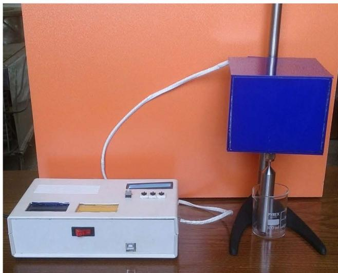
شکل ۱. نمای کلی ویسکومتر ساخته شده
