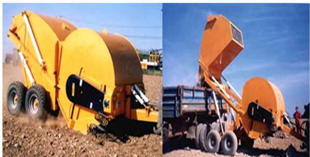
شکل ۹: مکانیسم تخلیه گن در سنگ جمع کن های تراکتوری کامل
