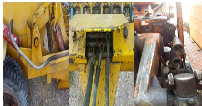
شکل ۱۰: مکانیسم اتصال به تراکتور در سنگ جمع کن های تراکتوری کامل
