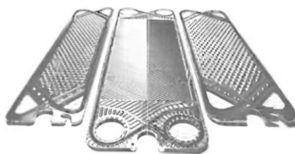
شکل ۳: الگوهای پرس شده روی صفحات مورد استفاده در یک مبدل حرارتی.
