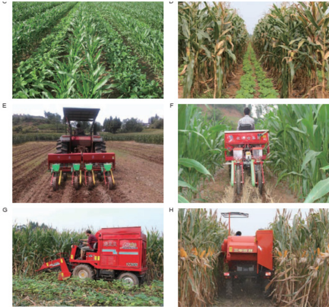
شکل ۶. طراحی ماشین‌آلات مخصوص در کشت مخلوط سویا-ذرت
