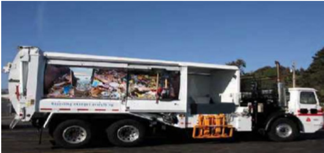
شکل ۳- کامیون جمع آوری مواد بازیافتی و سایر پسماندها در دو بخش مجزا در شهر سان فرانسیسکو
